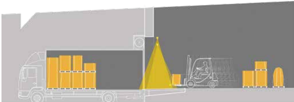
Optimierung: Mit der Volumenmessung kann die exakte Auslastung der Lkw ermittelt werden
